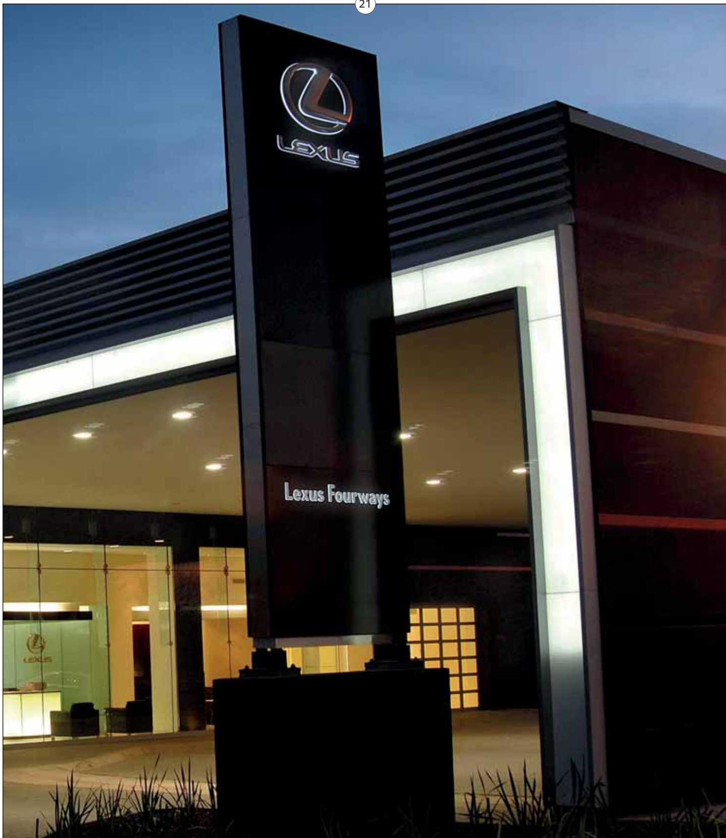
Große Leuchtbänder aus PLEXIGLAS truLED® in Verbindung mit LEDs lassen Lexus-Autohäuser in Südafrika erstrahlen – und das kostengünstig und energiesparend.
